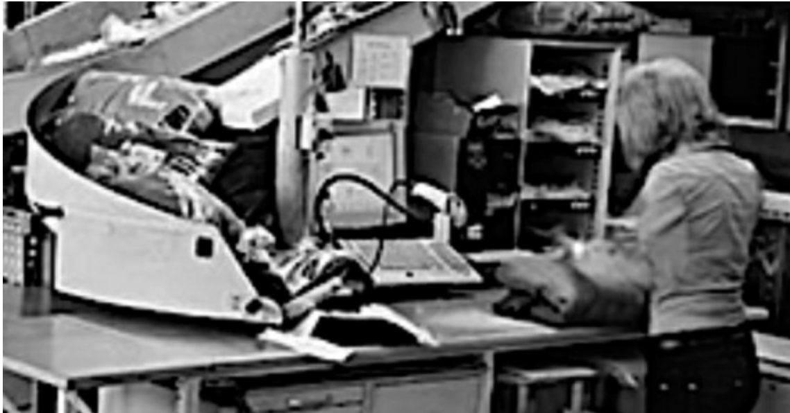
Figura 9.12. Transferencia del producto en flujo, por canaletas.
