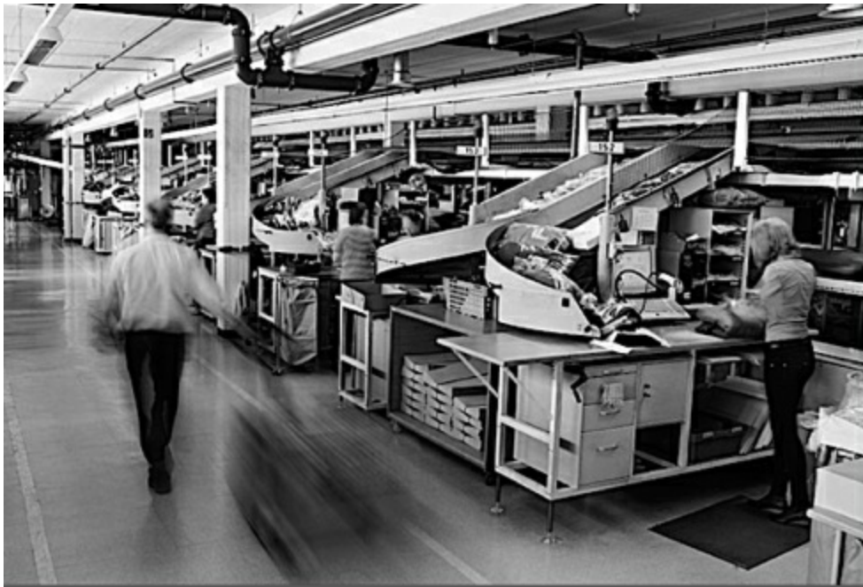
Figura 8.18. Aprovisionamiento de materiales mediante rampas deslizantes.
