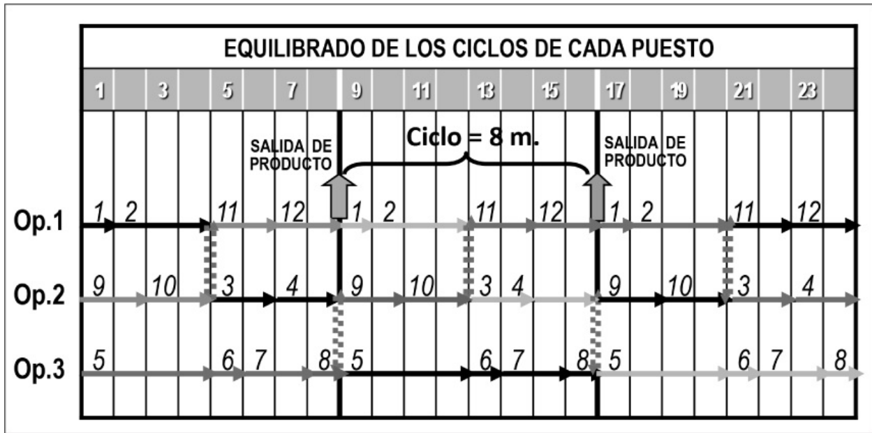
Figura 7.26. Diagrama OT de la célula única.
