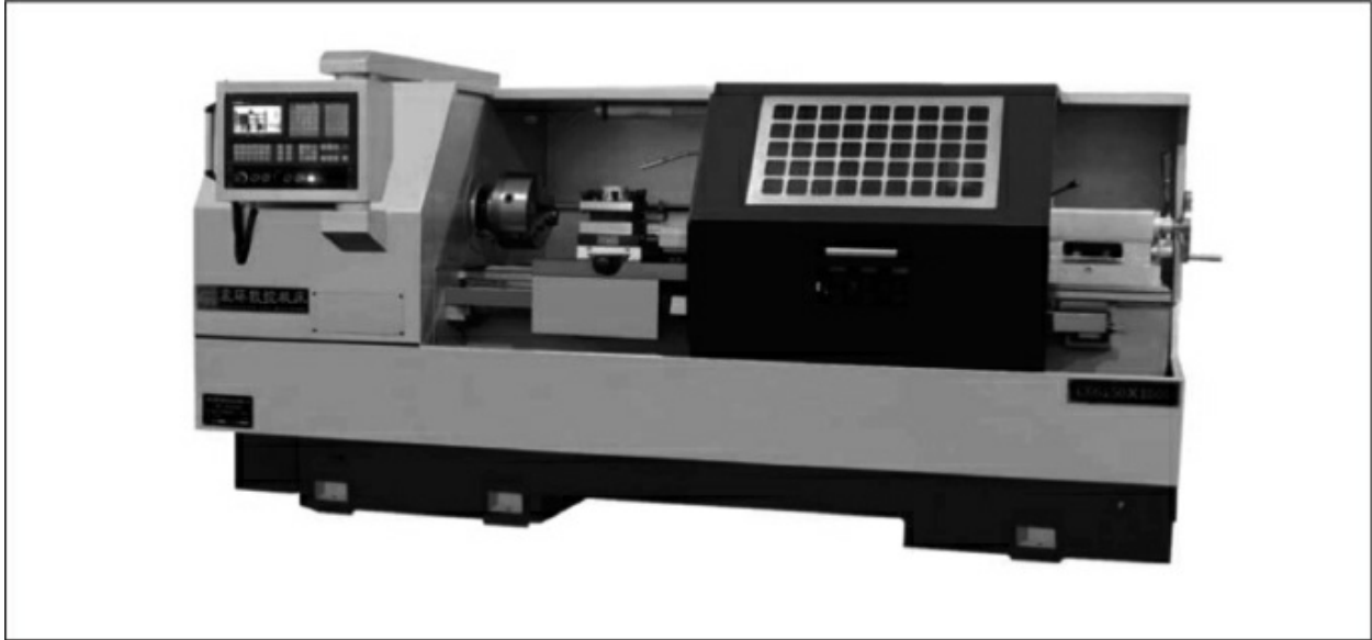
Figura 9.15. Máquina de control numérico típica de sistemas FMS.
