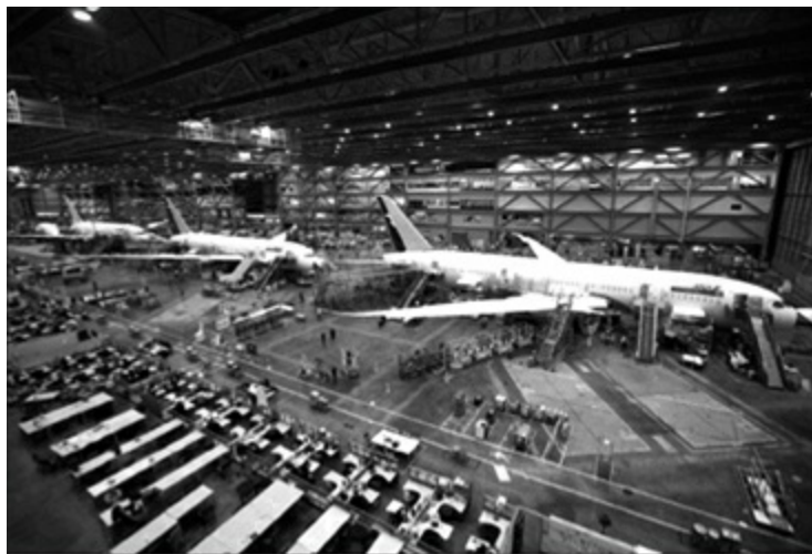
Figura 2.11. Línea de producción por cadena de puestos fijos.
