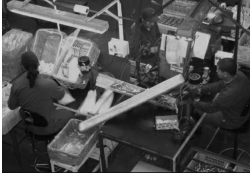
Figura 7.21. Establecimiento de flujo entre tres puestos.
